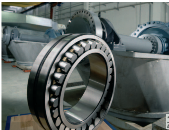
Figura 6 Cuscinetto orientabile a rulli FAG autoallineante per il supporto del rotore
