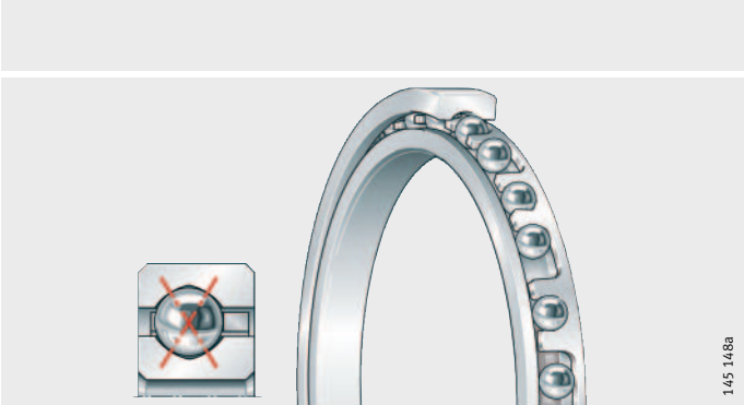
Cuscinetto a quattro punti di contatto Forma costruttiva X
