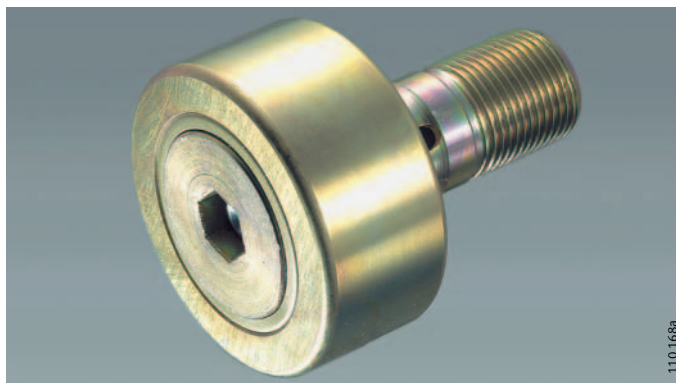
Figura 27 PWKR52-2RS-RR con rivestimento Corrotect® dopo il test in nebbia salina
