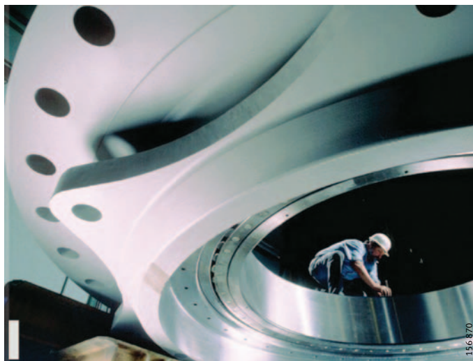
Figura 5 Montaggio di un cuscinetto volvente di grandi dimensioni
